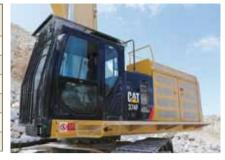
carico operativo della macchina regolando il regime del motore, mentre un sistema di autospegnimento lo arresta dopo un determinato intervallo di funzionamento al minimo. Oltre a risparmiare gasolio e ridurre le emissioni, questi sistemi prolungano significativamente gli intervalli di manutenzione.
