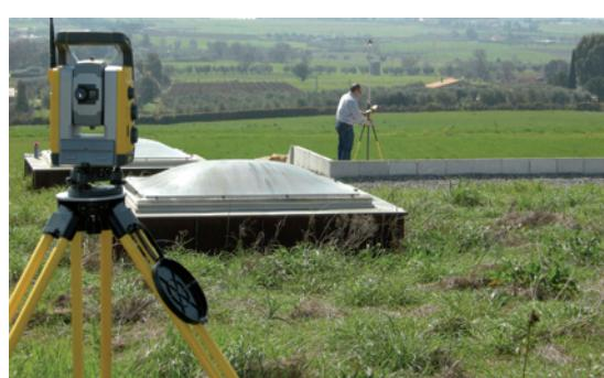
La stazione robotizzata e la palina con controller utilizzate dal Team CGT per fare il rilievo della conformazione del terreno da ripristinare per il lavoro di Capalbio.
