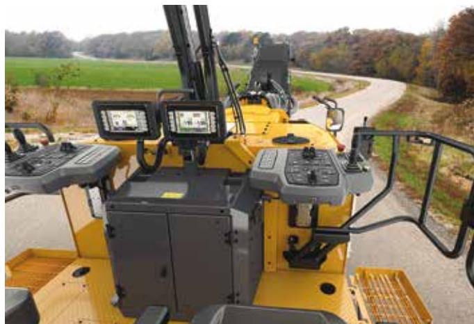
1. Le postazioni della PM620 e della PM820 sono uguali, con comandi intuitivi a portata di mano e confortevoli, protette da un tettuccio abbattibile idraulicamente
