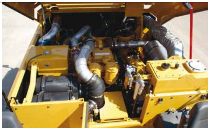
2. Il motore C19 Cat® della PM820 eroga una potenza di ben 800 CV con una curva di coppia ottimale per i lavori di fresatura ad alta produttività
