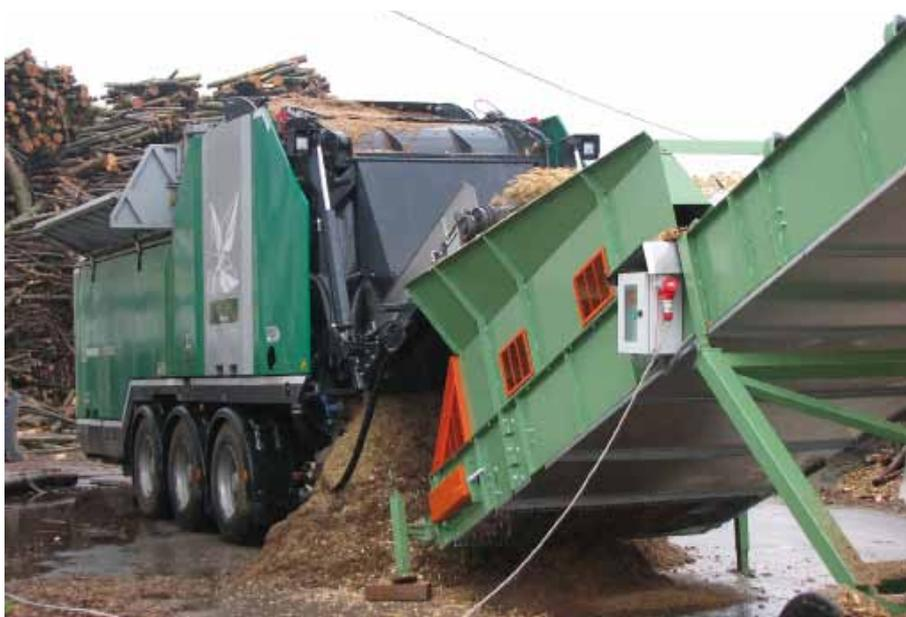
sili fissi e lame o coltelli, produce combustibile per impianti a biomassa.
