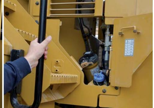
**NEI DETTAGLI** Da sinistra: il lube-system centralizzato (optional, in grado di servire fino a 14 punti di lubrificazione della macchina); il quadro dei comandi elettrici; i serbatoi del gasolio (capacità, 540 litri) e dell'urea (32 litri) in posizione protetta. Per ogni due pieni di gasolio, si effettua un pieno di urea: un modulo di consumo piuttosto basso rispetto alla concorrenza.
