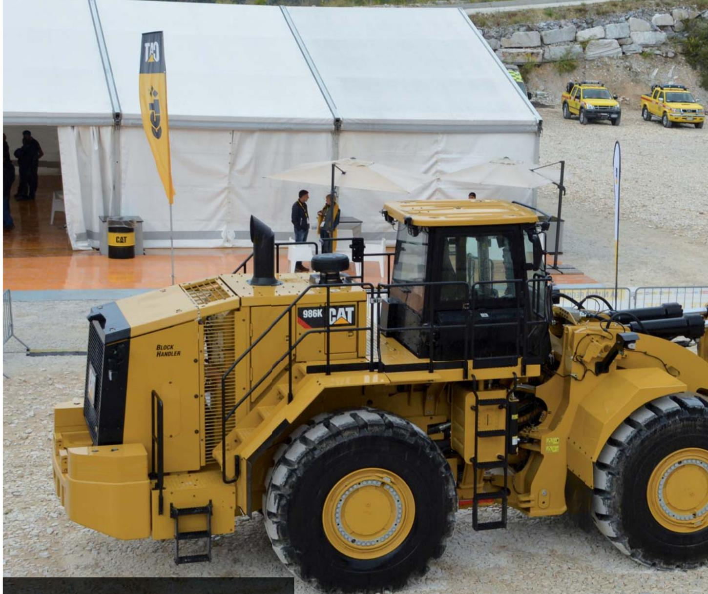
**DINAMICA VISIBILE** Con la prerogativa dei due cilindri di rovescio-benna, la 986K BH regala all'operatore una visibilità centrale importante per il lavoro con forche e il cambio attrezzatura.
