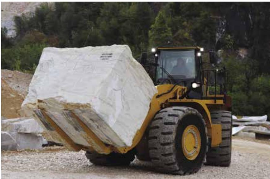
**IL LEVERISMO ANTERIORE CON BARRA A "Z" OTTIMIZZATO GARANTISCE LA MASSIMA CAPACITÀ DI SOLLEVAMENTO NELLE APPLICAZIONI DI MOVIMENTAZIONE BLOCCHI**
