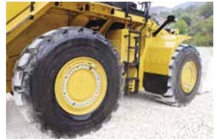
^ I CERCHI, COME NEL MODELLO 988K BH, SONO STATI MODIFICATI AL FINE DI GARANTIRE UNA MAGGIORE PORTATA. GLI PNEUMATICI UTILIZZATI (BRIDGESTONE O GOODYEAR) PRESENTANO UNA SPALLA AMPIA (QUASI 12 CM) PER EVITARE, SOPRATTUTTO NELL'ASSALE ANTERIORE, LO SLITTAMENTO DELLO PNEUMATICO STESSO
